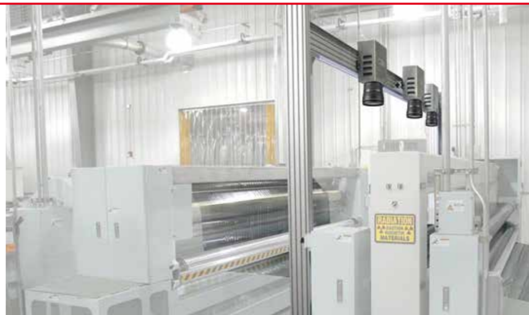
オプティカル品質管理システムによる PETフィルム押出(ソース: OCS)
