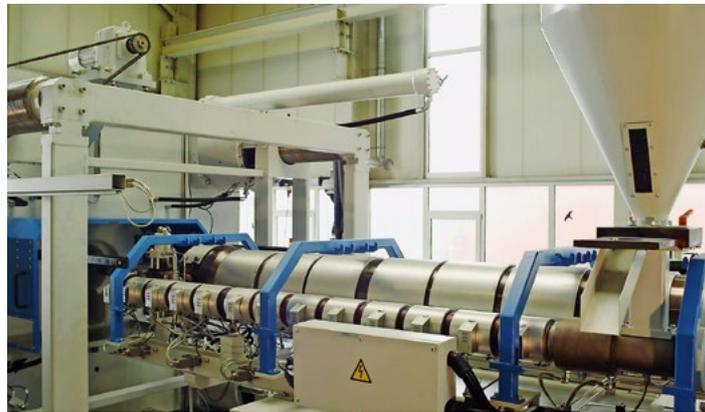
Die energieeffiziente, zweistufig arbeitende Spritzeinheit: Das Plastifizieren des Materials übernimmt ein Einschnecken-Hochleistungsextruder (vorn), das Einspritzen der Schmelze ins Werkzeug eine Kolbeneinheit (hinten); dazwischen ist ein Sperrschieber angeordnet. Foto: Ettlinger
