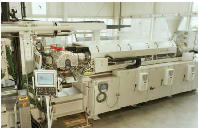
Bild 2. Die Plastifiziereinheit ist zweistufig ausgeführt. Der Plastifizierextruder ist mit einer Trommelfilter-Einheit kombiniert. Er arbeitet zyklussynchron diskontinuierlich und fördert die gereinigte Kunststoffschmelze in ein seitlich daneben positioniertes Kolben-Einspritzaggregat (links). Die Schließsysteme der Ettlinger-Spritzgießmaschinen sind in Zwei-Platten-Bauweise ausgeführt (rechts)
