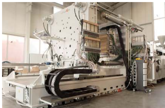
Bild 2. Die Plastifiziereinheit ist zweistufig ausgeführt. Der Plastifizierextruder ist mit einer Trommelfilter-Einheit kombiniert. Er arbeitet zyklussynchron diskontinuierlich und fördert die gereinigte Kunststoffschmelze in ein seitlich daneben positioniertes Kolben-Einspritzaggregat (links). Die Schließsysteme der Ettlinger-Spritzgießmaschinen sind in Zwei-Platten-Bauweise ausgeführt (rechts)
