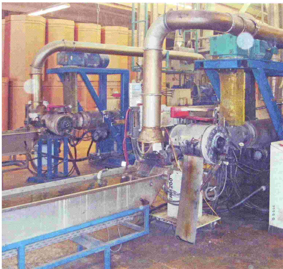
Druckkonstante Filterung und das Entfernen großer Mengen schwieriger Verschmutzungen aus Materialien des Dualen Systems ermöglichen die Produktion hochwertiger Regranulate.
