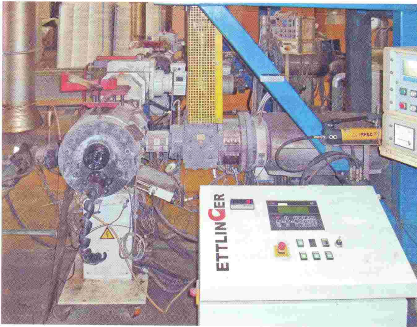
Der Filter reinigt Eingangsmaterial mit bis zu 16 Prozent Störstoffanteil mit einer Filterkartusche, die sich fünf bis 15 Mal in der Minute selbst reinigt.
