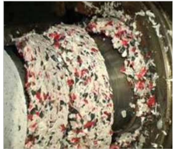
Kontinuierlicher Austrag von Gummi und Silikon aus einer Kunststoffschmelze. Aufgabematerial: Kühlschrankmahlgut. Störstoffanteil: 4 Prozent im Eingangsmaterial. Filter: ERF 2
