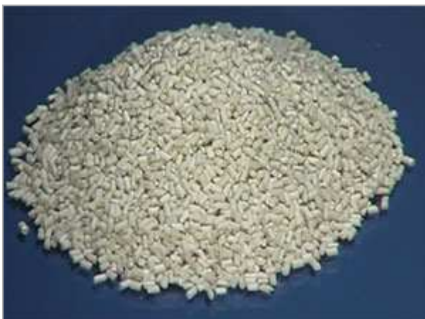
Granulat aus mit 4 Prozent Gummi und Silikon verunreinigtem Kühlschrankmahlgut. Filterfeinheit: 100µ; Filter: ERF 200
