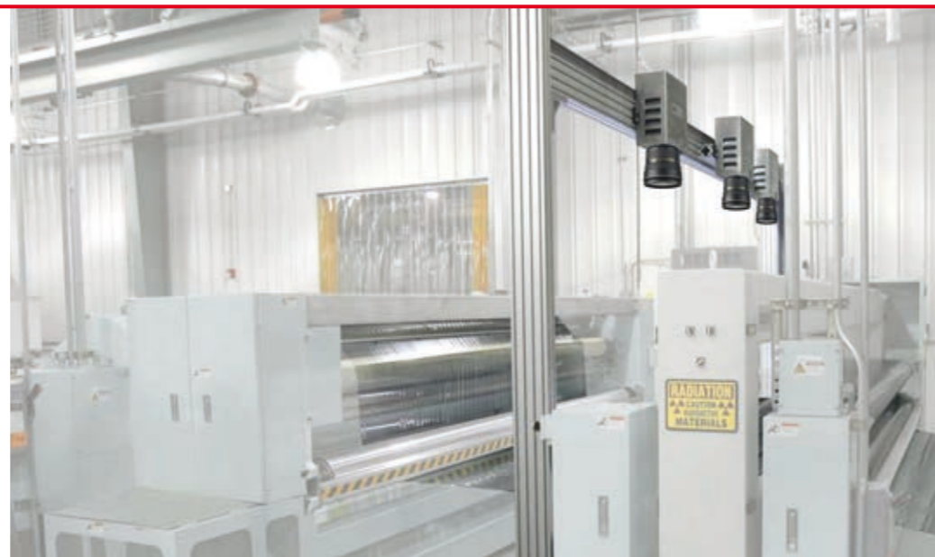
Extrusión de láminas PET con sistema óptico de control de calidad (fuente: OCS)
